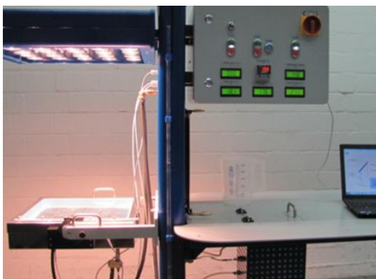
5 pav. Valdymo skydelis saulės kolektoriaus modulyje.
